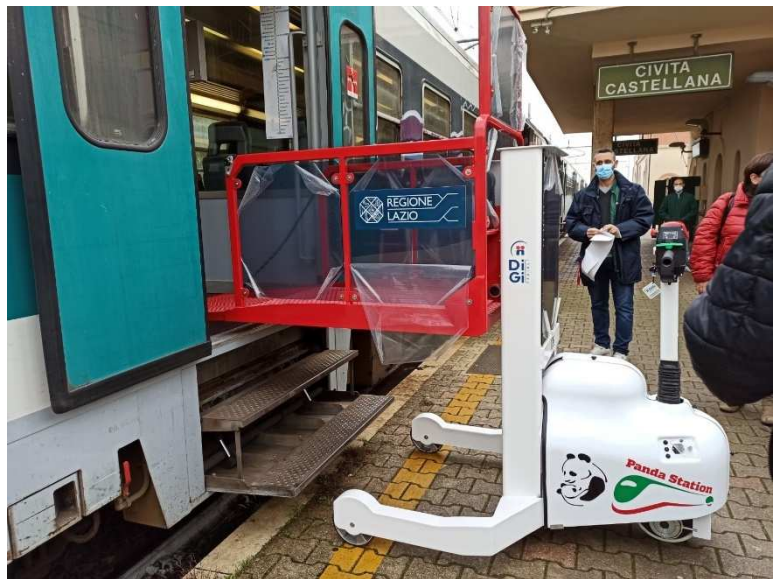
Fig. 13: avvicinamento del sollevatore al treno in modo che parte del cesto si trovi all'interno del convoglio
