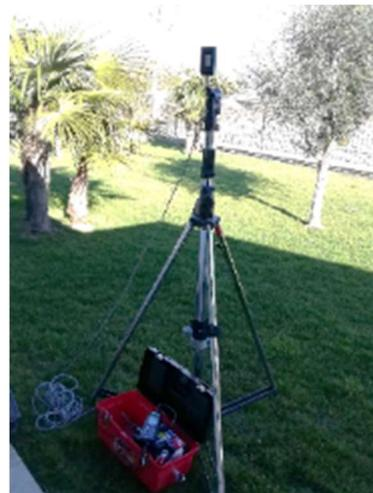
FIGURA 2 – FASE DI CALIBRAZIONE DELLA CATENA FONOMETRICA
