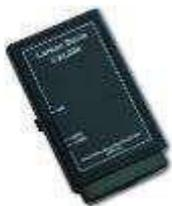
La calibrazione della strumentazione è effettuata tramite calibratore di livello acustico tipo CAL 200 della Larson Davis. Il calibratore acustico produce un livello sonoro di 94 dB rif. 20  $\mu$ Pa a 1 kHz, ha una precisione di calibrazione di +/-0.3 dB a 23°C; +/-0.5 dB da 0 a 50°C ed è alimentato tramite batterie interne (1xIEC 6LF22/9 V).
