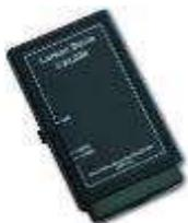
La calibrazione della strumentazione è effettuata tramite calibratore di livello acustico tipo CAL 200 della Larson Davis. Il calibratore acustico produce un livello sonoro di 94 dB rif. 20  $\mu$ Pa a 1 kHz, ha una precisione di calibrazione di +/-0.3 dB a 23°C; +/-0.5 dB da 0 a 50°C ed è alimentato tramite batterie interne (1xIEC 6LF22/9 V).
