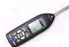
La strumentazione utilizzata è costituita da analizzatori in tempo reale Larson Davis 831 (Fonometri integratori di precisione in classe 1 IEC60651 / IEC60804 / IEC61672 con dinamica superiore ai 125 dB) dotati di Preamplificatore tipo PRM-831 con attacco Switchcraft TA5M e Microfono a condensatore da 1/2" a campo libero tipo PCB 377B02, le cui caratteristiche principali sono:
