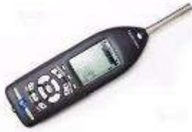
La strumentazione utilizzata è costituita da analizzatori in tempo reale Larson Davis 831 (Fonometri integratori di precisione in classe 1 IEC60651 / IEC60804 / IEC61672 con dinamica superiore ai 125 dB) dotati di Preamplificatore tipo PRM-831 con attacco Switchcraft TA5M e Microfono a condensatore da 1/2” a campo libero tipo PCB 377B02, le cui caratteristiche principali sono:
