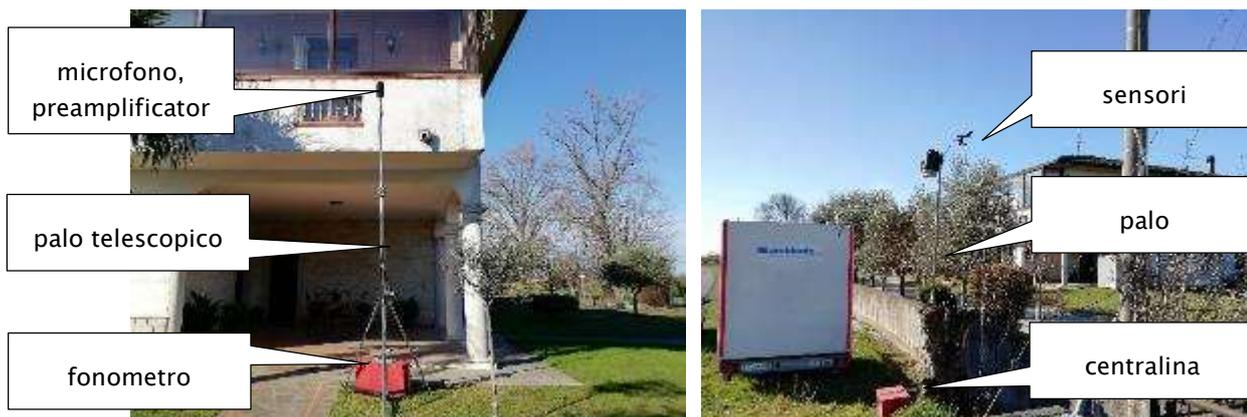
Per l'esecuzione del monitoraggio fonometrico è stata impiegata la strumentazione con le seguenti caratteristiche. Gli strumenti ed i sistemi di misura impiegati sono stati provvisti di certificato di taratura e controllati almeno ogni due anni per la verifica della conformità alle specifiche tecniche. Il controllo periodico è stato eseguito presso laboratori accreditati da un servizio di taratura nazionale ai sensi della legge 11 agosto 1991, n. 273.
