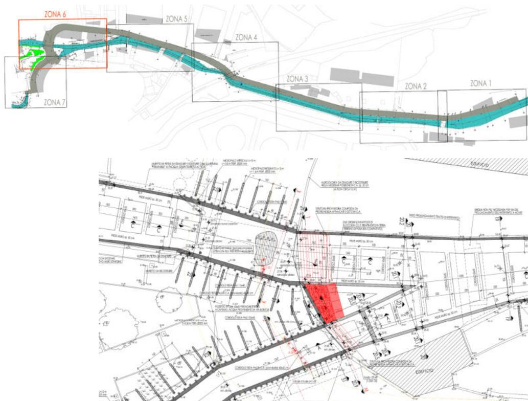
In alto: sviluppo dell'intervento – in basso: dettaglio strutturale.
